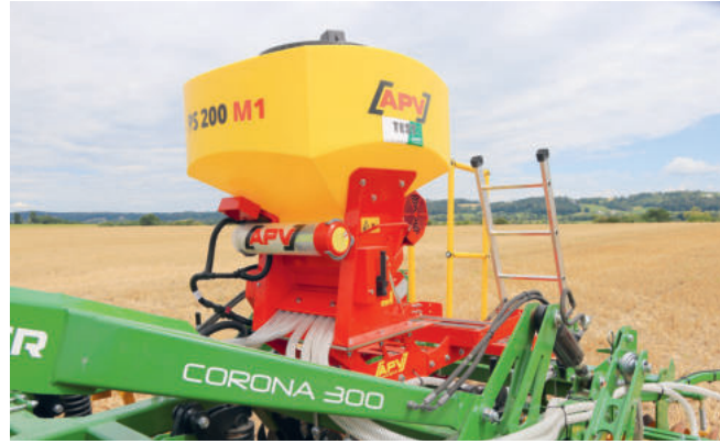
Sorgfältig verlegte Saatschläuche - keine Steigungen oder starke Krümmungen - sind für eine störungsfreie Saat Voraussetzung.
