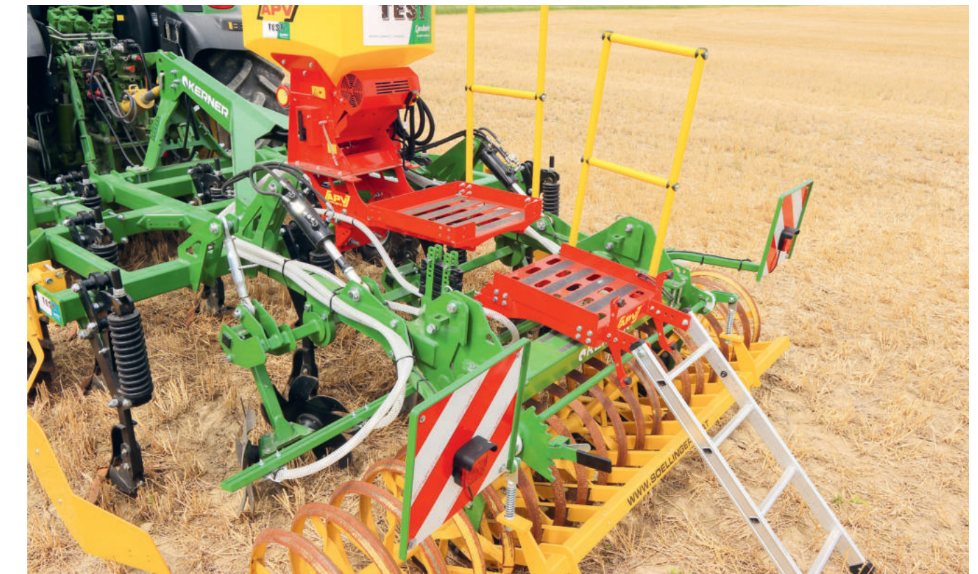
Der Saatgutbehälter ist mit der optionalen Leiter und dem Ladesteg gut und dank Geländer auch sicher erreichbar.
