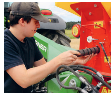
Die Säwelle lässt sich bei Saatgutwechsel einfach und rasch austauschen.
