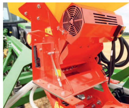
Elektrisches Gebläse: Mehr Luftleistung mit dem ISOBUS-M2-Steuermodul möglich.
