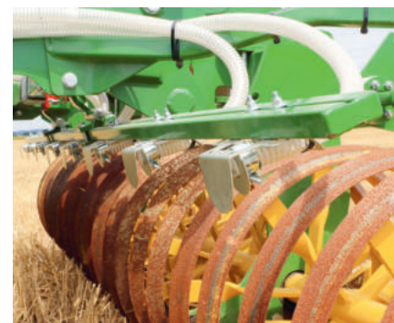
Beim 3 m breiten Grubber beträgt der Abstand der sechs Prallbleche 37,5 cm.
